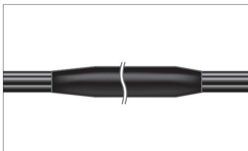
7.11. Монтаж муфты закончен. Дать ей остывть, прежде чем подвергать какому-либо механическому воздействию.
