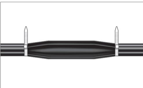
7.8. Сжать жилы вместе, как можно ближе друг к другу. Всжатом состояния нивместах окончания трубок для изоляции соединителей/гильз наложить бандажи с помощью нейлоновых хомутов. Обрезать свободные концы нейлоновых хомутов.
