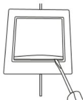
2.1. Снять клавишу путем легкого отжатия лезвием плоской отвертки боковой стенки клавиши.
