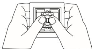
2.2. Снять рамку с заглушкой путем нажатия на механизм.
