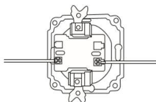
2.3. Присоединить провода, вставив защищенные концы в пазы контактных зажимов, затянув винты.
