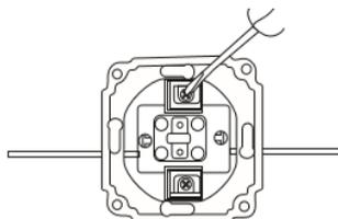
2.4. Установить механизм в отверстие в стене, зафиксировав его стопорными винтами, затянув их до упора.
