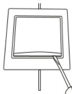
2.1. Снять клавишу путем легкого отката лезвием плоской отвертки боковой стенки клавиши.
