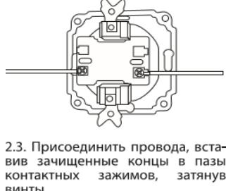
2.3. Присоединить провода, вставив зачищенные концы в пазы контактных зажимов, затянув винты.
