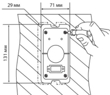
4.4. Продеть кабель в отверстие. Установить механизмы розетки и выключателя.
