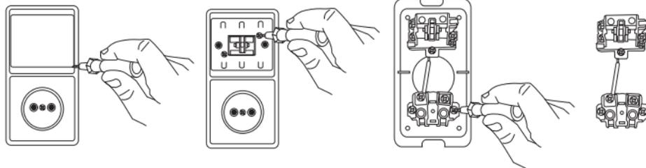
4.3. Установить основание в вырез в стене (либо прикрепить корпус изделия к стене 4-мя шурупами (в комплект поставки не входят).
