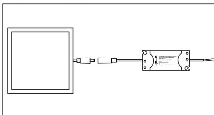
Рисунок 2. Соедините светильник с драйвером (драйверы поставляются под отдельными артикулами: SQ0329-0483, SQ0329-0213)
