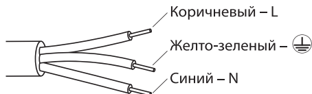
Рисунок 1. Схема подключения светильника
