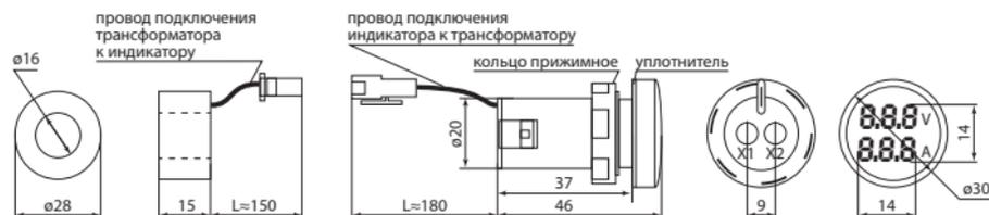
Рисунок 1. Габаритные и установочные размеры индикаторов
